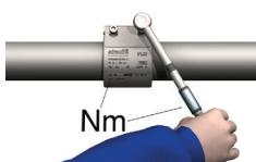
Mit Drehmomentschlüssel Schrauben wechselseitig festziehen. Auf der Kupplung angegebenes Drehmoment und Angaben beachten.
