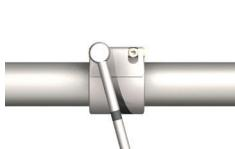
Kupplung ausrichten und Schrauben wechselseitig mit Ratschenschlüssel oder Akkuschrauber leicht anziehen.
